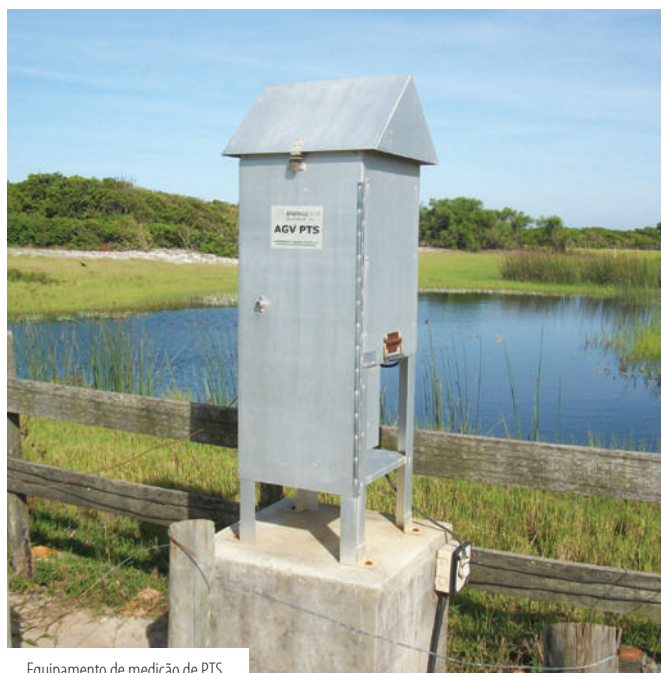
Equipamento de medição de PTS
