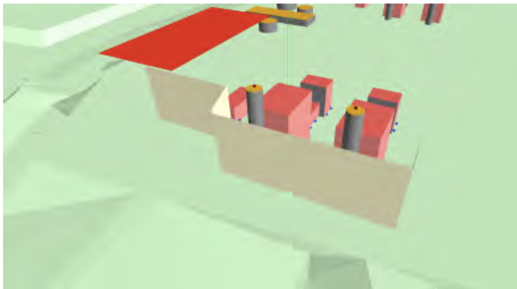
Figura 11.4.3-1 Indicação do layout da barreira acústica (imagem extraída da simulação acústica GROM)
